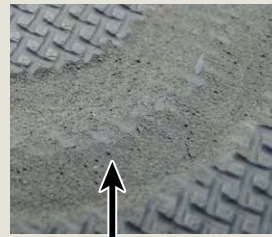
マットの表面が大きく摩耗し、マット内部がむき出しに。これにより、クッション性能も低下します。
